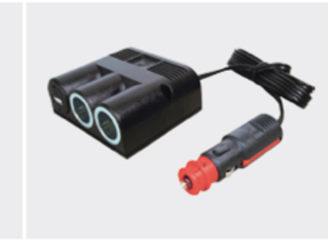
R418/3U Adattatore spina 12V universale / 2 prese 12V auto Ø 21 + presa USB 5V 3A cavo L= 1,5m
