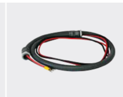
KT5-C10 KIT CABLAGGIO PER PASSACAVO "KT5" composto da guaina L=1m e due cavi da 6mm² L=2m. Completo di raccordi PG11 e capicorda per il collegamento al modulo fotovoltaico.
